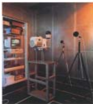
↑ Чтобы гарантировать высочайший стандарт качества, мы используем строгую, компьютеризированную процедуру тестирования для всех вращательных насосов серии RV, включая сложную проверку уровня шума.
