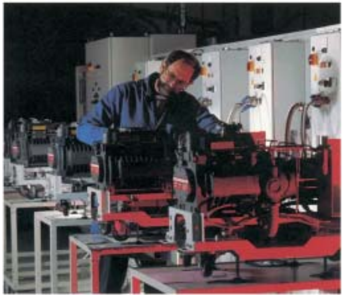
↑ Всеобъемлющее тестирование, с использованием разработанного компанией Edwards программного обеспечения, сухих насосов новейшей серии iQ, предназначенных для полупроводниковой промышленности.
