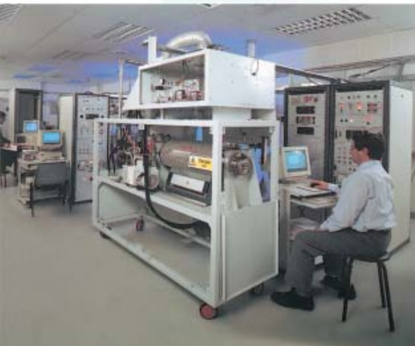
На участке одного из предприятий группы ВРС, работающего в области промышленных газов в Crawley, Англия, исследователи компании Edwards моделируют технологические процессы при производстве полупроводниковых устройств для тестирования и совершенствования сухих насосов. На снимке – установка, моделирующая нитридный процесс химического осаждения из газовой фазы при пониженном давлении.
